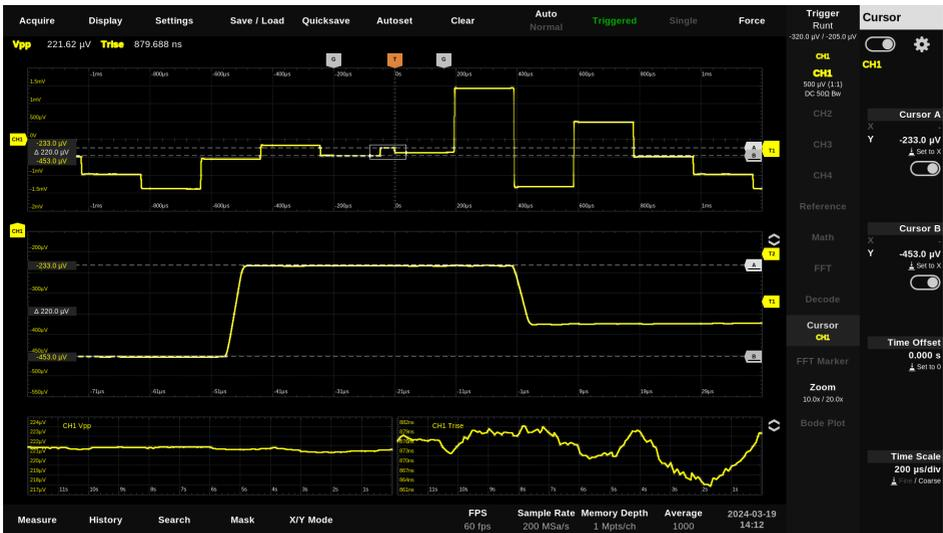
Der Screenshot zeigt die Triggerung auf ein nur 220  $\mu\text{V}$  (!) großes Signaldetail. In der Zoomansicht (Mitte) sehen Sie das Signaldetail in 50  $\mu\text{V}/\text{Div}$  Auflösung und die Measurement-Trend-Charts (unten) zeigen den zeitlichen Verlauf der Vpp-Spannung und der Anstiegszeit von diesem Signalausschnitt.
