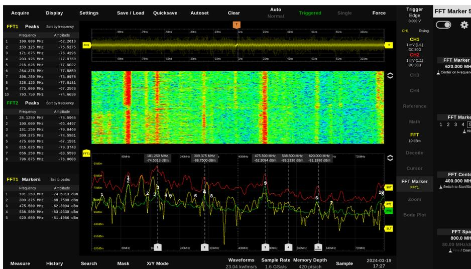
Für den Screenshot wurde eine BicoLog Antenne ohne Verstärker direkt an den Eingang des Magnova angeschlossen. Oben ist das Signal im Zeitbereich zu sehen, unten die Amplituden im Frequenzbereich NF bis 800 MHz mit Spektrum-, Average- und Max-Hold-Anzeige und in der Mitte der zeitliche Verlauf des Spektrums in einer Wasserfallanzeige. Links sind einige Peaks und Markerwerte in Tabellenform dargestellt.
