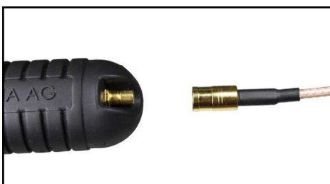
Jede Probe besitzt einen SMB-Schnellanschluss...
