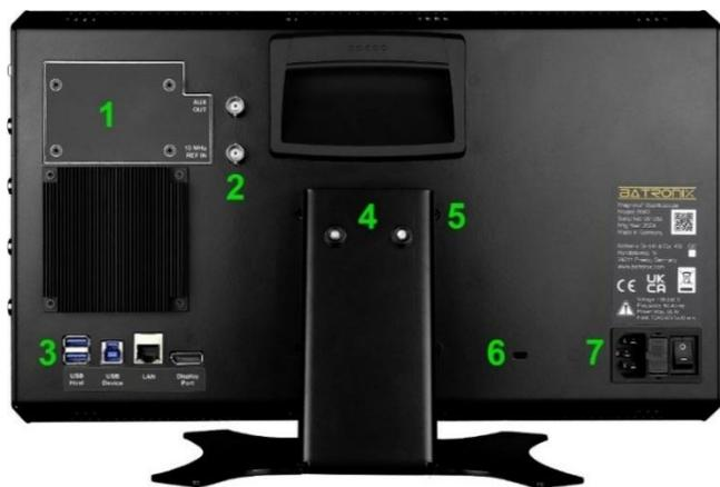
1. Abdeckung für den nachträglichen Einbau des Magnova Funktionsgeneratormoduls. Weiterhin als Wartungsöffnung zum einfacheren Zugang zu der Batterie für die eingebaute Real-Time-Clock. Zum Lösen und Festziehen der Schrauben wird ein Schraubendreher mit TX10-Kopf benötigt.
