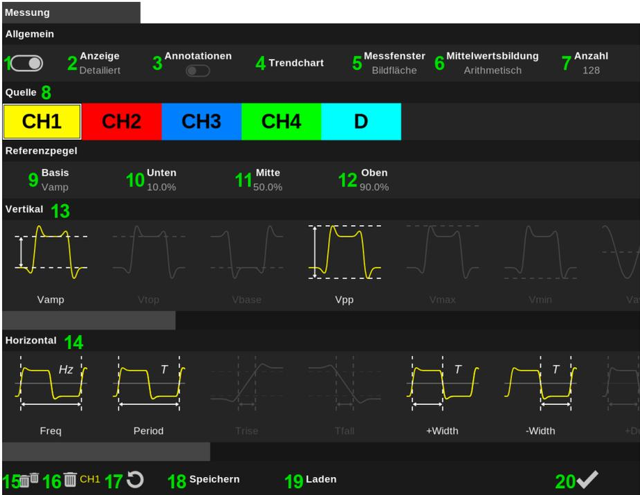
1. Die Anzeige der Messwerte kann mit dem Schieber ein- und ausgeschaltet werden.
