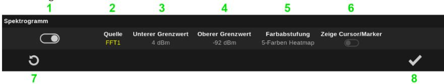
1. Die Anzeige des Spektrogramms kann mit dem Schieber ein- und ausgeschaltet werden
