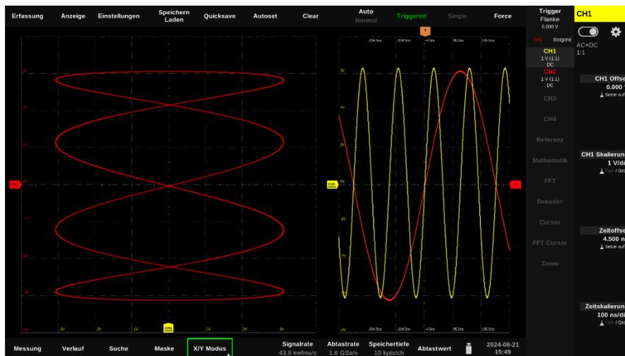
Zum Anzeigen der XY-Darstellung tippen Sie bitte auf „X/Y Modus“ (X/Y Mode) am unteren Bildschirmrand. Stellen Sie in dem dann angezeigten Dialog die Kanäle ein und tippen Sie auf den Schieber, um die Darstellung zu aktivieren oder wieder zu beenden.
