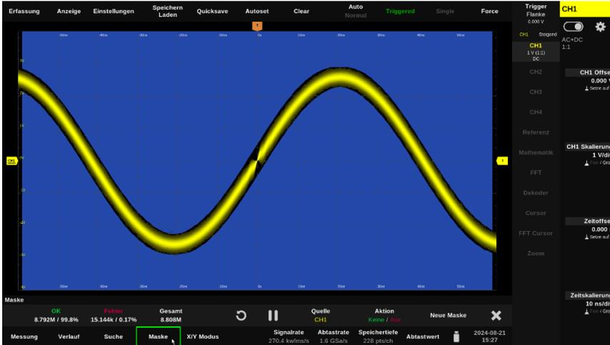
Zum Anzeigen der Maskentest-Steuerleiste tippen Sie bitte auf „Maske (Mask)“ am unteren Bildschirmrand. Mit einem erneuten Antippen können Sie diese wieder schließen.
