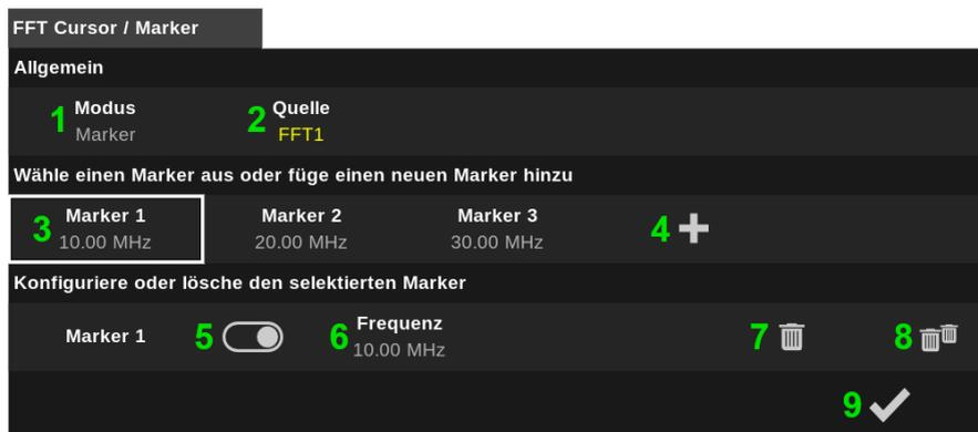
1. Mit der Modus-Einstellung kann zwischen den Cursors und den Markern umgeschaltet werden. Daraufhin wird auch der Eintrag in der Steuerungswahl passend benannt angezeigt.
