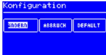
In den Konfigurationsmodus gelangen Sie, indem Sie beim Einschalten der I-CON den I-OP für 5 Sekunden gedrückt halten.
