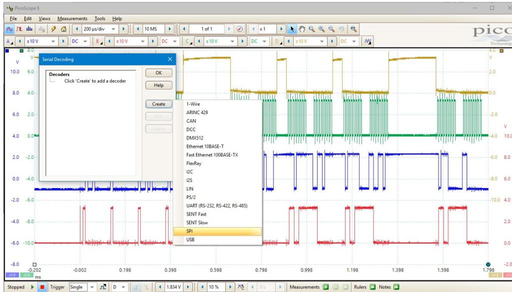
**El FORMATO DE GRÁFICO** muestra los datos descodificados (en hexadecimal, binario, decimal o ASCII) en un diagrama temporal, bajo la forma de onda y con un eje de tiempo normal, con las tramas erróneas marcadas en rojo.
