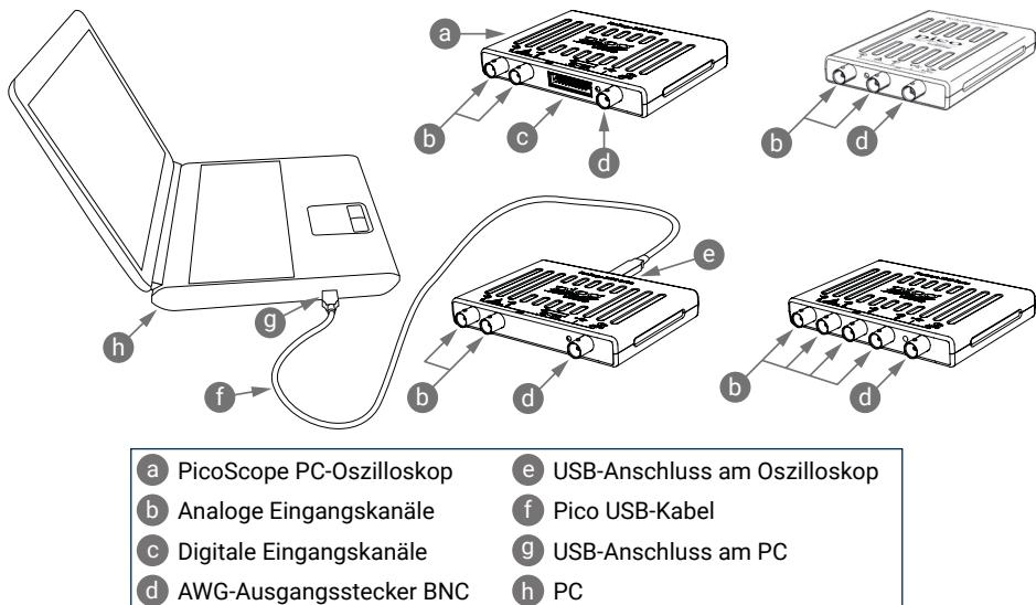
2. Abwarten, bis das Oszilloskop auf dem PC installiert ist. Währenddessen erscheint eine Meldung oder ein Symbol in der Taskleiste, und meldet, dass das Gerät gefunden wurde.
