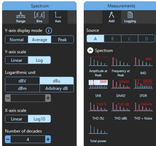
*Un éventail exhaustif de paramètres vous permet de contrôler le nombre de bandes de spectre (groupes TFR), le dimensionnement (y compris log/log) et le mode d'affichage (instantané, moyenne ou maintien de crête). Une sélection de fonctions de fenêtre vous permet d'optimiser la sélectivité, la précision ou la plage dynamique.*
