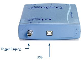
An der Rückwand des PicoScope 4262 befinden sich zwei Anschlüsse: ein USB-Anschluss zur Verbindung mit einem PC und eine BNC-Buchse zum Anschließen eines externen Triggers.
