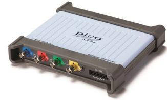
Todos los osciloscopios PicoScope 5000D de memoria profunda tienen una velocidad de muestreo máxima de 1 GS/s, conectividad USB 3.0 y un generador de formas de onda arbitrarias ([AWG](#)), además de las siguientes especificaciones:
