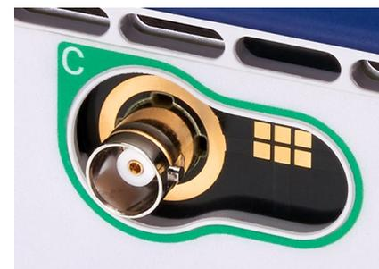
Con un'interfaccia con sonda intelligente sui canali dalla C alla F su modelli a 8 canali e tutti i canali su modelli a 4 canali, PicoScope serie 6000E supporta sonde attive innovative con un design meccanico a basso profilo per facilità di connettività e basso carico del dispositivo sotto esame.
