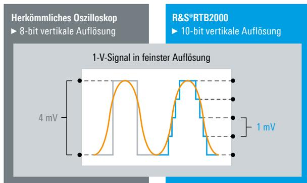
Dabei müssen die Spannungen über dem Schalttransistor im ein- und ausgeschalteten Zustand innerhalb der gleichen Erfassung bestimmt werden. Für präzise Messungen kleiner Spannungskomponenten ist eine hohe Auflösung von mehr als 8 bit essenziell.
