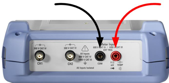
**Figure 4-1:** Entradas de medidor para ligação de pontas de teste
