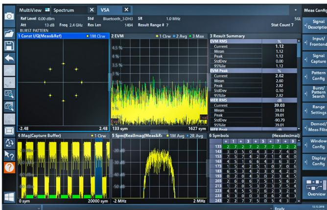
Demodulation eines DVB-SX2-Multi-Modulationssignals mit der Option R&S®FPL1-K70M (Option R&S®FPL1-K70 erforderlich)
