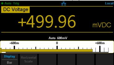
Diagram 2- 64 Bar Meter Display Mode
