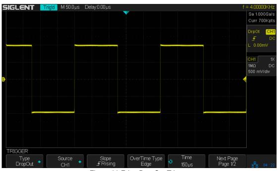
Figure 30 Edge DropOut Trigger
