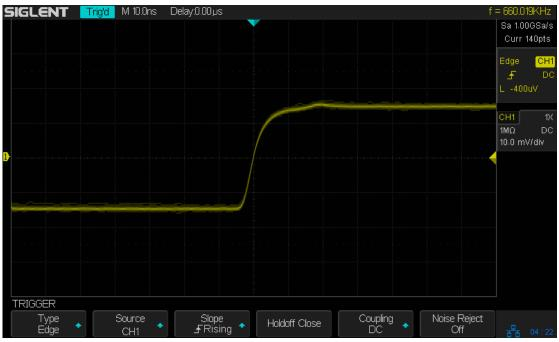
Figure 23 Edge Trigger
